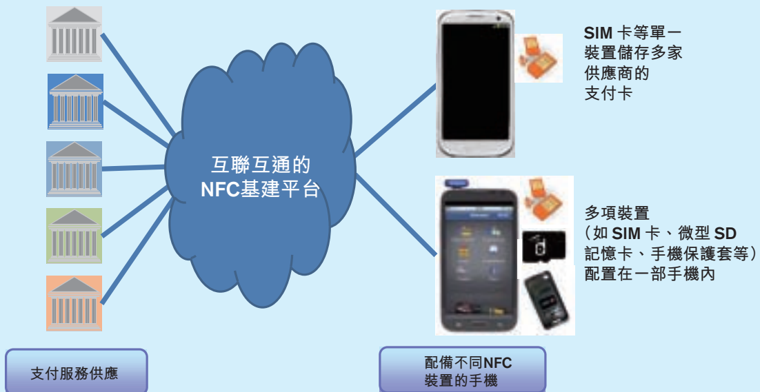
多家支付服務供應商與多項NFC裝置連接的互聯互通模型
